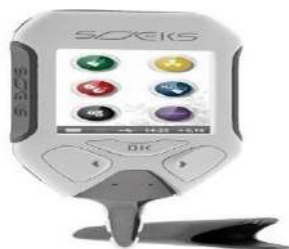
Рисунок 1. прибор Эковизор F4- для контроля качества овощей и фруктов
